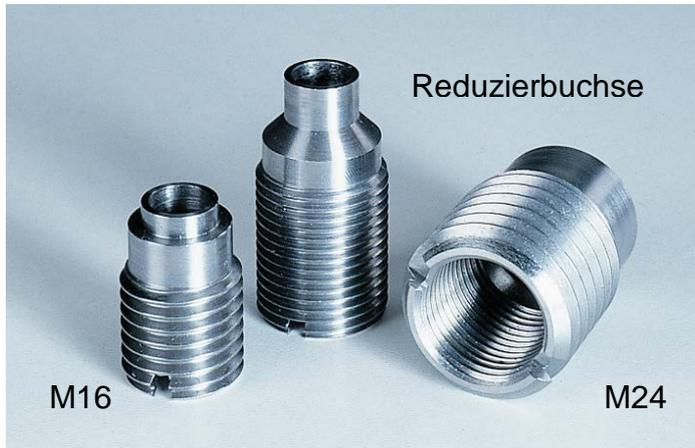
Die von Gneuß entwickelte Einsatzbuchse zur Messfühleraufnahme bietet dem Anwender von Messfühlern wesentliche Erleichterungen und hilft Kosten zu sparen. Spezialbearbeitungswerkzeuge entfallen, ein Standard-Gewindeschneider M24 oder M16 genügt zur Herstellung der Aufnahmebohrung.
